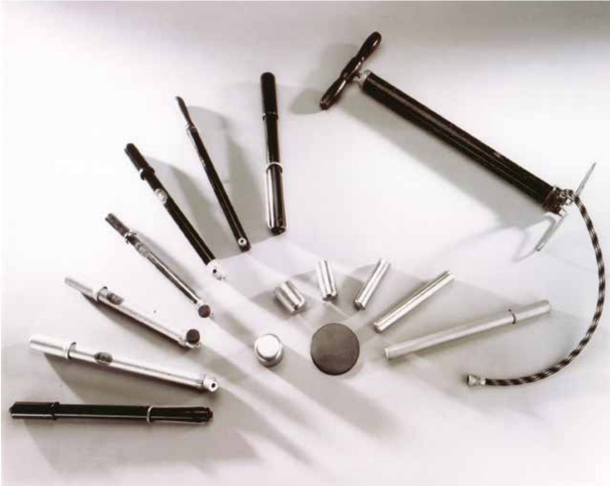
In der Mitte ist die Abfolge der einzelnen Tiefziehschritte von der Platine bis zur fertigen Luftpumpe zu sehen. Die Aufnahme stammt aus den 1950er-Jahren.
